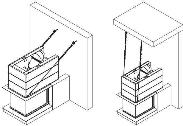
Выравнивание накладки производится с использованием уровня. Во время монтажа и устройства топочной камеры необходимо проследить за тем, чтобы несущая рама и накладка не были размещены ниже кожуха дверцы топки. Следует убедиться в том, что дверцу топочной камеры можно сдвинуть вверх или открыть вбок для выполнения чистки. **Дверца топочной камеры должна перемещаться и открываться легко и без сопротивления.**
