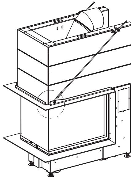
заказчик должен выполнить крепление самонесущей накладки. Для этого следует отсоединить штанги от топки и закрепить их на стенке или потолке. В зависимости от конструкции стены для этого можно использовать, например, закладные анкерные крепления в комбинации со стальными цепями.
