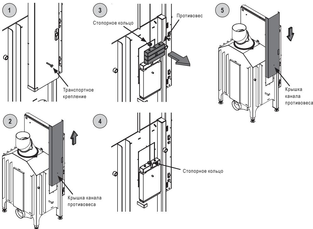
1. Снять транспортные крепления и открутить крепежные винты.
