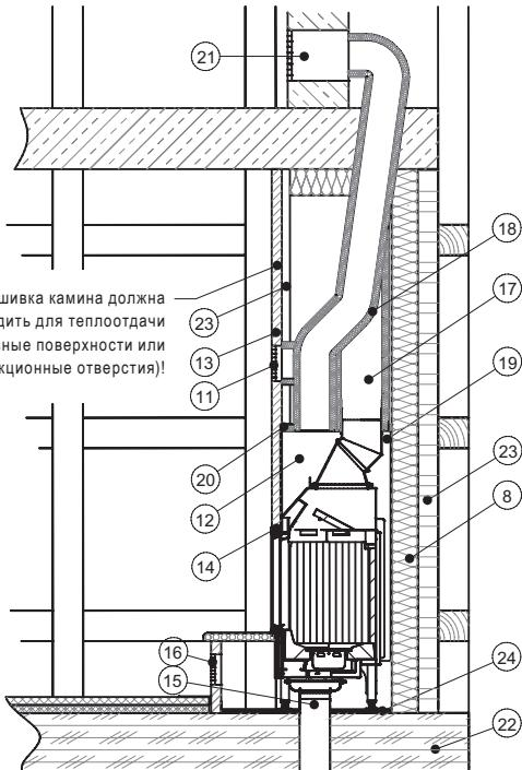
На рисунке показан пример монтажа топки Varia 1V-51-4S с кожухом теплого воздуха, этот пример действителен для любой топки.
