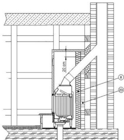
8 Изоляция топочной камеры, например, из недеформируемой минеральной ваты, согласно толщине теплоизоляции, указанной в технических характеристиках
