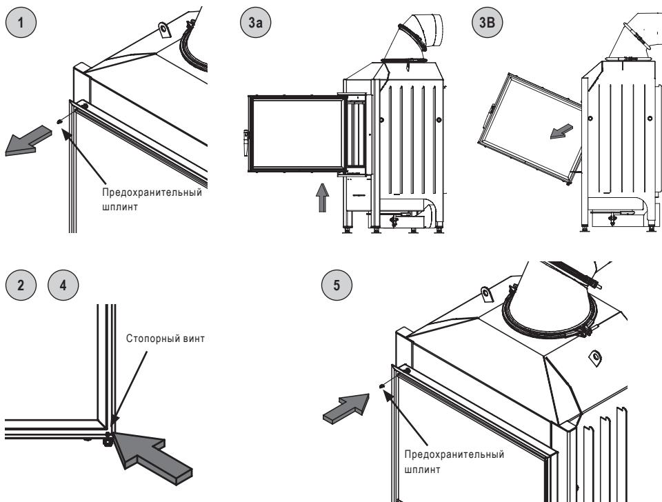
1. Вынуть предохранительный шплинт между рамой и дверцей.
