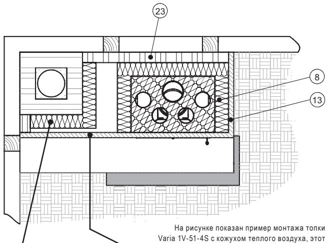
На рисунке показан пример монтажа топки Varia 1V-51-4S с кожухом теплого воздуха, этот пример действителен для любой топки.
